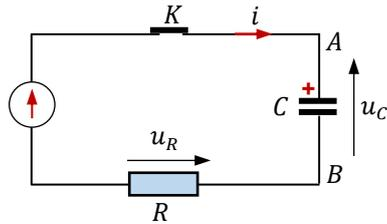
لدينا مكثفة سعتها  $C = 100 \mu F$  مشحونة تماما تحت توتر كهربائي  $U = 6 V$ . مثلنا جهة التيار
