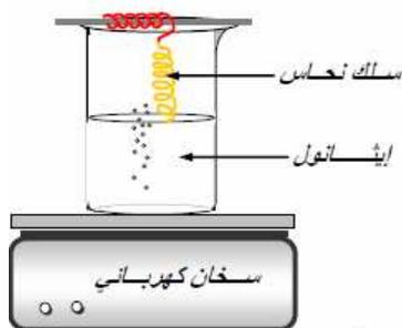
نسخن سلك من النحاس حتى الإحمرار في بخار الكحول الإيثيلي المزوج مع الهواء ، فلاحظ مباشرة ازدياد توهج سلك النحاس و يتشكل نتيجة لذلك مركب له رائحة التفاح عبارة عن الإيثانال
